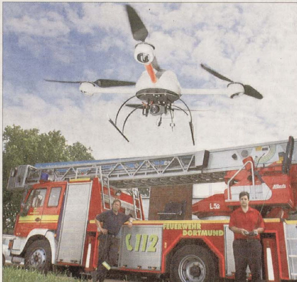
Vier Propeller treiben die Drohne an, die in drei Jahren vollgepackt mit Sensorik und Kommunikationstechnik bei Katastrophen aufsteigen soll. (Fotos [2]: Knut Vahlensieck)
