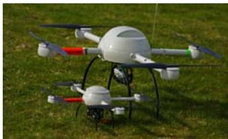
Abhängig von Nutzlast und Akku, sowie Windgeschwindigkeit und Temperatur erreicht das System Flugzeiten von bis zu 70 Minuten. Mit der optionalen Videobrille sind darüber hinaus Flüge außerhalb der Sichtweite möglich.
