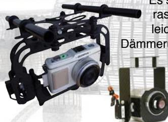
Es stehen Foto- und Videokameras mit hoher Auflösung, sowie leichtgewichtige Tageslicht-, Dämmerungs- und Wärmebild- bzw. Thermalkameras zur Verfügung. Alle Nutzlasten der md4-200 können auch an der md4-1000 eingesetzt werden.
