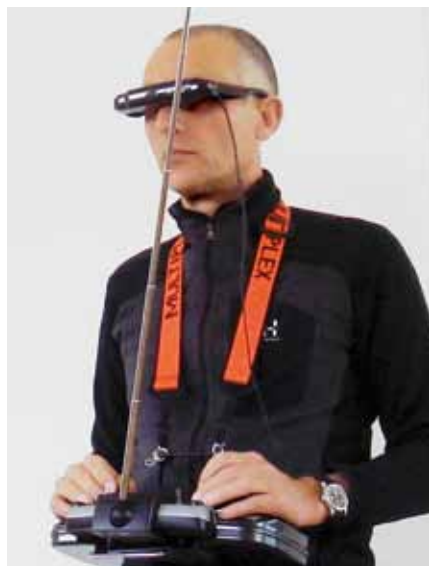
Mit der Videobrille oder dem Videobild auf dem PC-Bildschirm kann die Drohne auch ausserhalb des Sichtbereiches geflogen werden.
